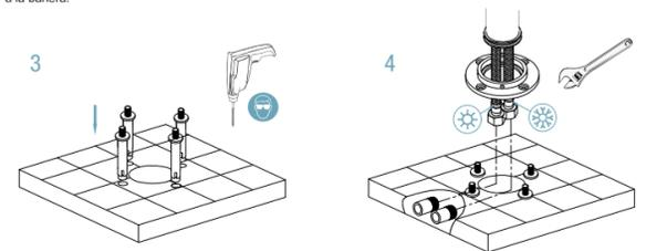
Taladre el piso sobre las siluetas anteriormente realizadas con una mecha de widia  $\phi 10$  mm hasta una profundidad de 50 mm y posteriormente coloque los anclajes metálicos hasta su tope.
