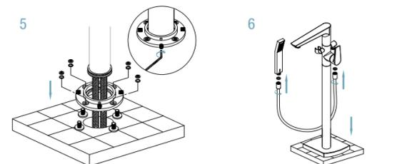
Coloque la base metálica\* y realice la fijación de la misma con las respectivas tuercas y arandelas provistas.
