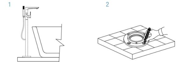
Planeé la ubicación de la grifería teniendo en cuenta el espacio de trabajo para realizar la conexión de las mangueras flexibles a las tuberías de distribución de agua fría y agua caliente, y la provisión de agua a la bañera.
